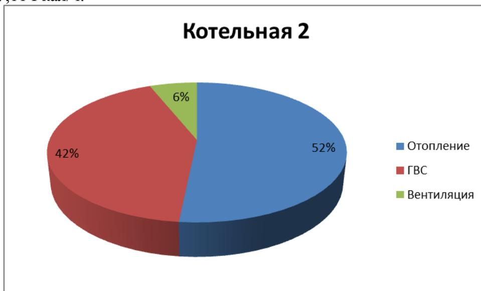
Рисунок 1.3 – Тепловые нагрузки потребителей, подключенных к котельной №2
