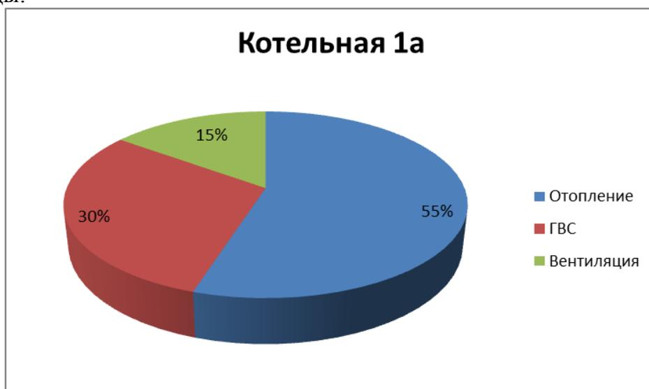
Рисунок 1.2 – Тепловые нагрузки потребителей, подключенных к котельной №1а
