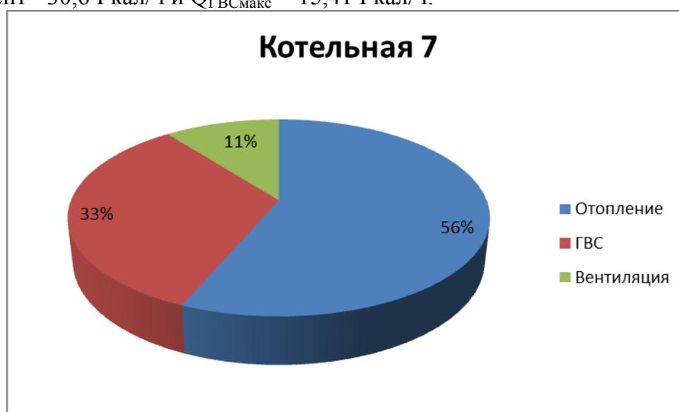
Рисунок 1.7 – Тепловые нагрузки потребителей, подключенных к котельной №7
