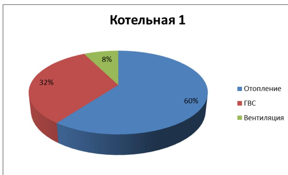
Рисунок 1.1 – Тепловые нагрузки потребителей, подключенных к котельной №1
