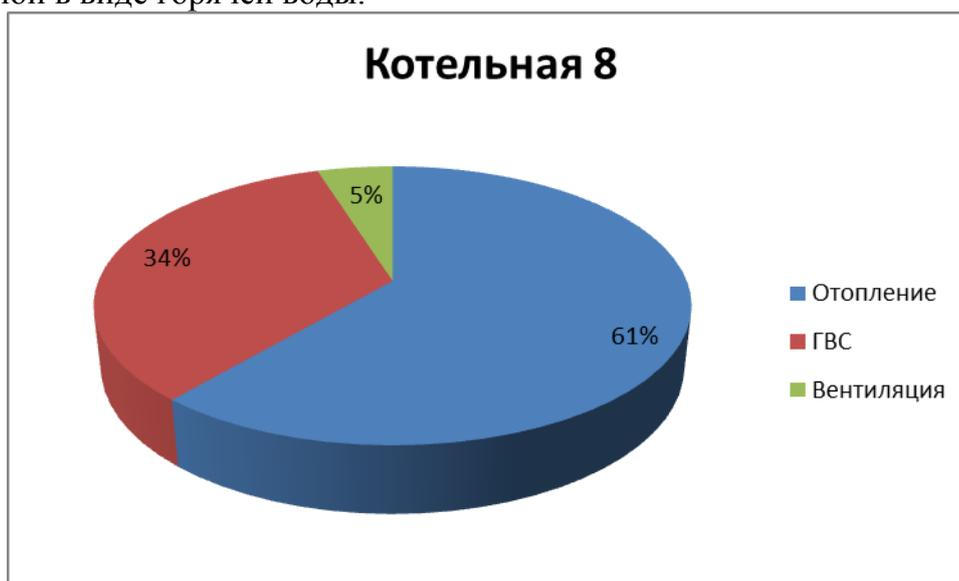
Рисунок 1.8 – Тепловые нагрузки потребителей, подключенных к котельной №8
