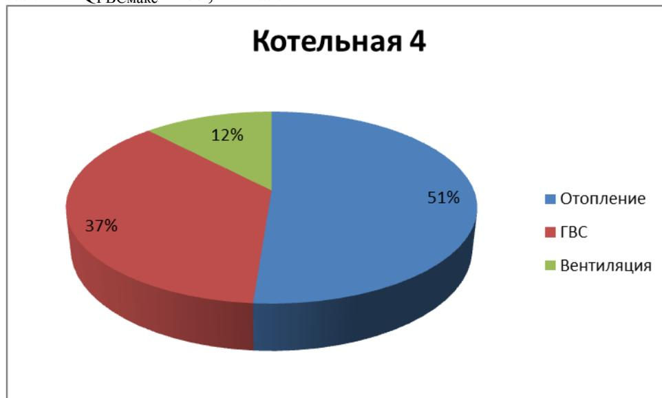
Рисунок 1.5 – Тепловые нагрузки потребителей, подключенных к котельной №4
