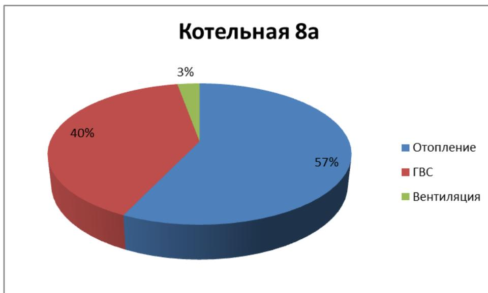
Рисунок 1.9 – Тепловые нагрузки потребителей, подключенных к котельной №8а
